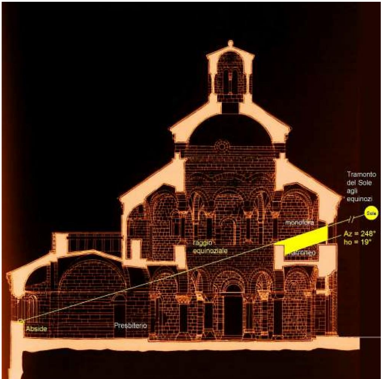
Schema del fenomeno della proiezione del raggio equinoziale nella Rotonda di San Tomè in Almenno San Bartolomeo
